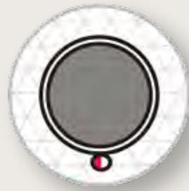
Gedämmte Rohrleitung mit Sensorkabel
