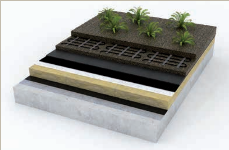
Aubau einer Dachflächenheizung im Gründach und Heizmatten Typ ABR-Dach.
