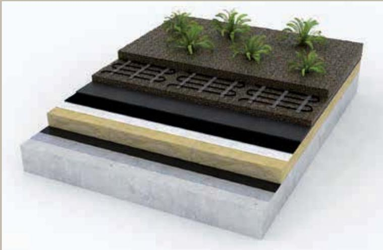
Aubau einer Dachflächenheizung im Gründach und Heizmatten
