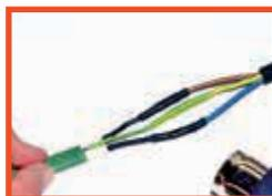
Schrumpfschläuche 35 mm mittig über die Pressverbinder schieben und aufschumpfen.
