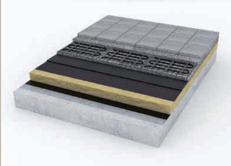
Aubau einer Dachflächenheizung mit Steinbelag und Heizmatten
