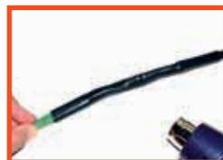
Großen Schrumpfschlauch 220 mm für äußere Isolierung und Abdichtung über die Verbindungsstelle schieben und aufschumpfen.
