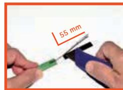
Heizelement 55 mm entlang beider Litzen auftrennen.
