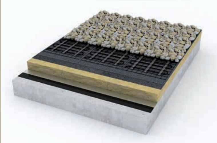
Aubau einer Dachflächenheizung mit Rollkies und Heizmatten
