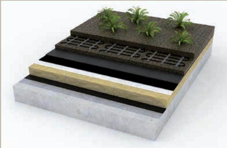
Aubau einer Dachflächenheizung im Gründach und Heizmatten
