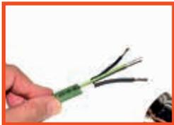
Schieben Sie entsprechend des Fotos die Schrumpfschläuche stramm bis ans Ende der Litzen.
