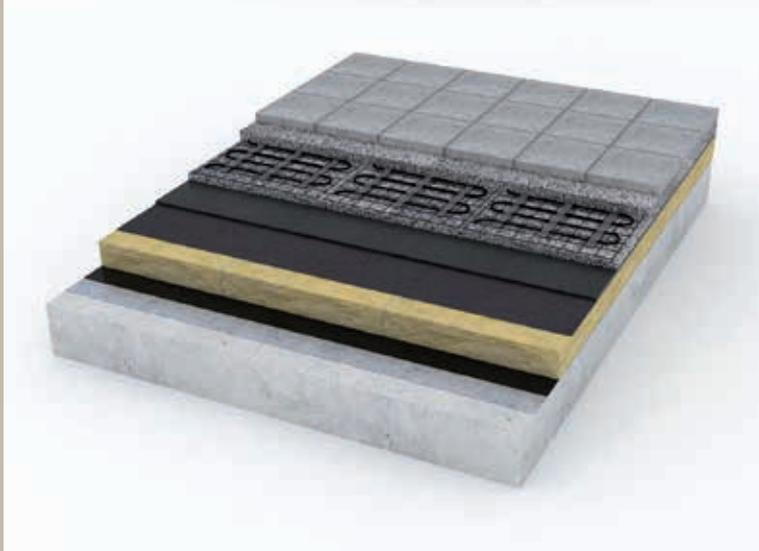
Aubau einer Dachflächenheizung mit Steinbelag und Heizmatten
