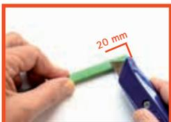
Heizleitung gerade abschneiden und 20 mm der äußeren Isolierung entfernen.
