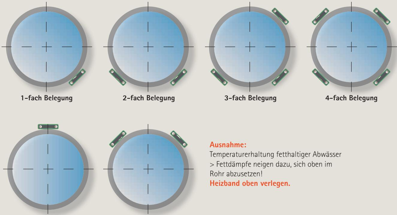
1-fach Belegung      2-fach Belegung      3-fach Belegung      4-fach Belegung
