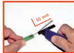
Heizelement 55 mm entlang beider Litzen auftrennen.
