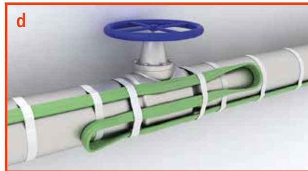
Verlegung an Ventilen
