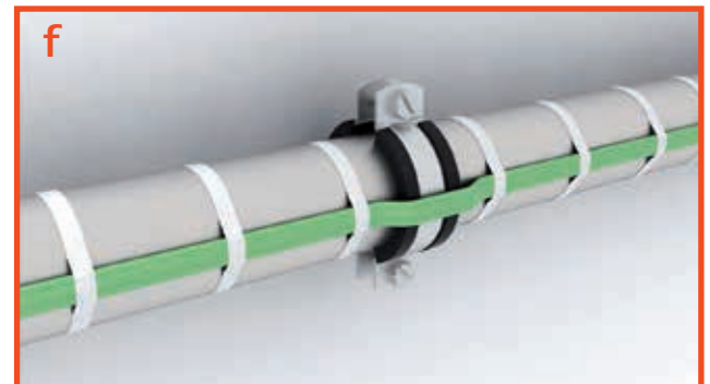
Verlegung an Schellen
