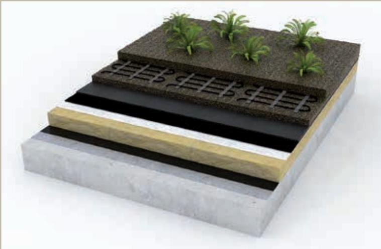
Aubau einer Dachflächenheizung im Gründach und Heizmatten
