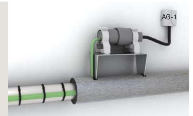
Anschlussstechnik auf Rohrleitung unter der Wärmedämmung.
