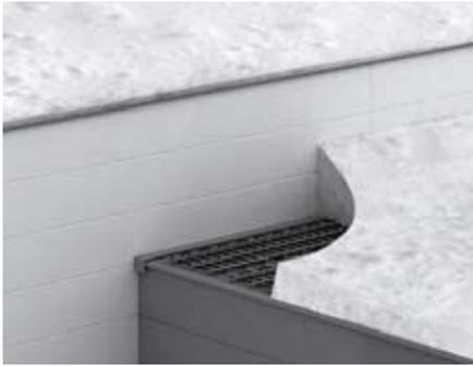
Bei einigen Dachflächen kann es sinnvoll sein Heizschleifen vom Typ BHLR einzusetzen. Dann werden erst die Montagestege 8000-62.13 auf dem Untergrund befestigt und dann die Heizleitung darin verlegt. Auch hier wird ein maximaler Abstand von 15 cm gewählt, sodass auch eine Flächenleistung von ca. 200 Watt/m<sup>2</sup> installiert ist.
