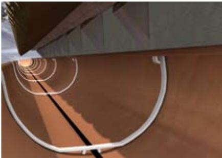
Verlegung des Heizbandes 1-fach bei Dachrinnen von 120 bis 150 mm Breite, Befestigung alle 1,5 m mit KC-Kunststoffclip, Alternativ Befestigung alle 2,5 m mit Abstandshalter ASH (ASH-Set besteht aus 5 x ASH + Kabelbinder) in Längsrichtung des Heizbandes.
