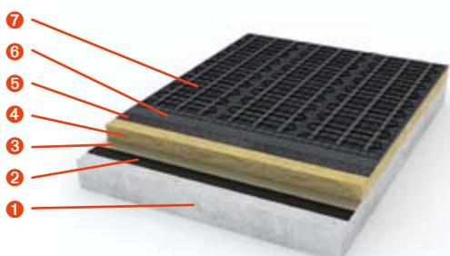
Auf der oberen EPDM-Dichtungsbahn werden die Heizmatten ABR-Dach gemäß Plan verlegt. Das Glasfaserträgergewebe sollte auf dem Dach verklebt oder verschweißt werden, sodass die Heizmatten gegen Verschieben gesichert sind.
