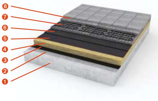
Direkt in Splittbettung werden die Heizmatten ABR-Dach gemäß Plan verlegt. Das Gewebe muss immer so verlegt sein, dass der Heizleiter oberhalb liegt.
