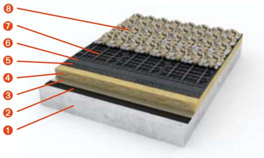
Auf der oberen Dichtungsbahn werden die Heizmatten ABR-Dach gemäß Plan verlegt. Das Glasfaserträgergewebe muss nicht auf dem Dach verklebt oder verschweißt werden, da hierbei der Rollkies die Fixierung übernimmt. Maximale Überdeckung des Heizleiters 30 mm.
