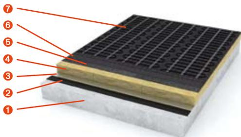
Auf der oberen Bitumen-Schweißbahn werden die Heizmatten ABR-Dach gemäß Plan verlegt. Das Glasfaserträgergewebe sollte auf dem Dach verklebt oder verschweißt werden, sodass die Heizmatten gegen Verschieben gesichert sind.
