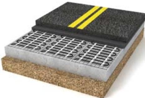
Auf die Betonsohle des Untergrundes werden in einer ersten Schicht Gussasphalt die Heizmatten Typ ABR gemäß Plan verlegt und eingebettet. Die Kaltleiter werden seitlich an den Heizmatten vorbei zu den Anschlusspunkten geführt.
