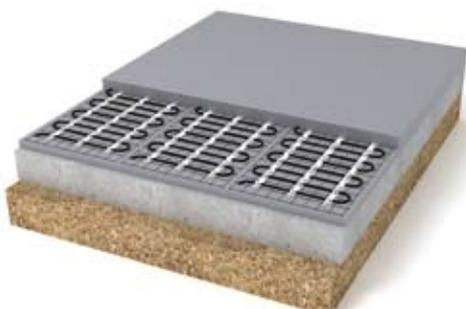
Sollte baulich bedingt eine stärkere Estrichschicht gefordert sein, so wird vor der Verlegung der Heizmatten erst eine Schicht Estrich geschüttet, dann werden die Heizmatten verlegt und direkt danach wird die zweite Schicht Estrich eingebracht.
