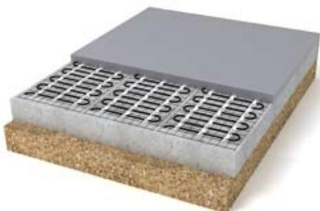
Auf der Betonsohle des Untergrundes werden die Heizmatten/ Heizschleifen entsprechend der bamaheat® Planungsunterlagen ausgelegt und ggf. am Untergrund befestigt. (Achtung evtl. vorhandene Abdichtung nicht beschädigen!) Die Kaltleiter werden seitlich an den Heizmatten vorbei zu den Anschlusspunkten geführt.
