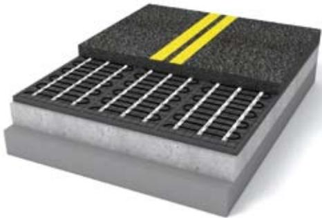
Auf die Betonsohle des Untergrundes wird die erste Schicht Asphalt, mit einer Stärke von etwa 25 mm, gegossen. Im Anschluss werden nach dem Abkühlen der ersten Asphaltschicht die Heizmatten gemäß Plan verlegt. Das Glasfasergewebe verhindert ein Aufschwemmen der Heizmatten. Die Kaltleiter werden seitlich an den Heizmatten Typ ABR vorbei zu den Anschlusspunkten geführt. Abschließend folgt die zweite Asphaltschicht, die eine Stärke von etwa 30-70 mm erreichen sollte.
