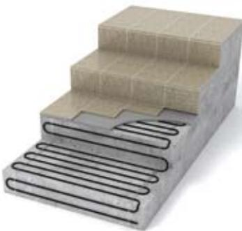
Bei großen Treppen/Podesten können im Einzelfall ebenfalls Heizmatten zum Einsatz kommen. Aufgrund der oft sehr kleinen Einzelflächen kommt die Heizleitung Typ BL 28 mit einseitigem Anschluss zum Einsatz. Auf dem Untergrund (Rohtreppe) der zu beheizenden Flächen wird die Heizleitung Typ BL 28 oder Typ BHLR-30 mit Montagestegen befestigt. Der Heizleitungsabstand ergibt sich aus der benötigten flächenbezogenen Leistung, W/m<sup>2</sup> (siehe Montagehinweis Heizschleifen Punkt 6.8.).
