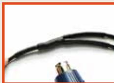
Die 3 Schrumpfschläuche (120 mm) nacheinander über die Enden des Abzweigschieben und mit dem Heissluftfön erwärmen, bis diese gleichmäßig anliegen und etwas Schmelzkleber an den Enden austritt.
