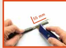
Heizelement 55 mm entlang beider Litzen auftrennen.
