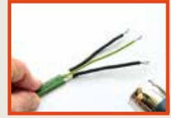
Die schwarzen Schrumpfschläuche und den grün/gelben Schrumpfschlauch (Ø 4 mm, Länge 50 mm) über die vorbereiteten Litzen schieben und schrumpfen.
