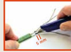
Litzen freischneiden, verdrillen und einen Rest der Isolierhülle von 5 mm stehen lassen.
