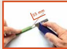
Heizelement 55 mm entlang beider Litzen auftrennen.
