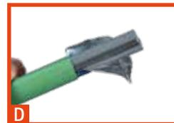
Äußere Heizbandisolation bis zur 1. Markierung 33 mm entfernen. Schutzleiterlitze nicht beschädigen - Aufwölben der Isolierschicht vermeiden.
