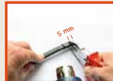
Über das vorbereitete Heizbandende einen kurzen Schrumpfschlauch mit 5 mm Überstand aufschumpfen und dabei das Ende mit einer Flachzange zusammendrücken und so verkleben.
