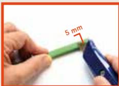
Heizleitung gerade abschneiden und 5 mm der äußeren Isolierung entfernen.
