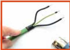
Adernhülsen auf Anschlussleitungen quetschen und Schrumpfschlauch wie zu sehen schrumpfen. Beim Aufschrumpfen des kurzen Schrumpfschlauches (20 mm) den Bereich zwischen den Leitern mit einer Spitzzange zusammendrücken und somit miteinander verkleben.
