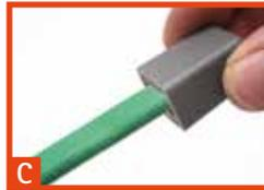
**C** Endabschluss bis zum spürbaren Anschlag (mind. 20 mm) auf das Heizband schieben.
