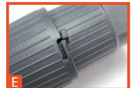
Vorbereitetes/(-e) Heizband/Heizbänder vollständig bis zur Markierung 82 mm einschieben! Bei Anschluss von 2 Heizbändern vorhandenen Blindstopfen entfernen.
