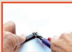
Schutzleiterlitze an der Heizleitung abschneiden.
