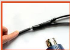
Abzweigschrumpfschlauch mit dem Heisslüftfön erwärmen, bis diese gleichmäßig an den 3 Heizbändern anliegt und etwas Schmelzkleber an den Enden austritt. Achtung nicht überhitzen!
