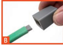
**B** Äußere Isolierung und Schutzleiterlitze bis zur Markierung 5 mm entfernen.
