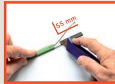
Heizelement 55 mm entlang beider Litzen auftrennen.
