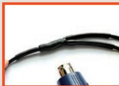
Die 3 Schrumpfschläuche (120 mm) nacheinander über die Enden des Abzweigschieben und mit dem Heisslüftfön erwärmen, bis diese gleichmäßig anliegen und etwas Schmelzkleber an den Enden austritt.
