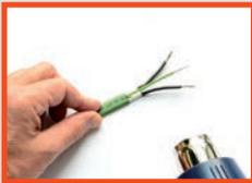
Die schwarzen Schrumpfschläuche und den grün/gelben Schrumpfschlauch (Ø 4 mm, Länge 50 mm) stramm bis ans Ende der Litzen schieben und aufschumpfen.
