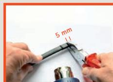
Über das vorbereitete Heizbandende einen kurzen Schrumpfschlauch mit 5 mm Überstand aufschumpfen und dabei das Ende mit einer Flachzange zusammendrücken und so verkleben.
