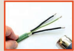
Die schwarzen Schrumpfschläuche und den grün/gelben Schrumpfschlauch (Ø 4 mm, Länge 50 mm) über die vorbereiteten Litzen schieben und schrumpfen.
