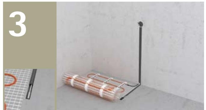
b) Verlegen sie den Kaltleiter (Anschlussleitung Heizmatte) falls erforderlich seitlich der beheizten Fläche bis zur Anschlussdose. Der Kaltleiter darf den Heizleiter nicht kreuzen oder berühren! Halten sie einen Mindestabstand von 2 cm zu den Heizleitern ein.
